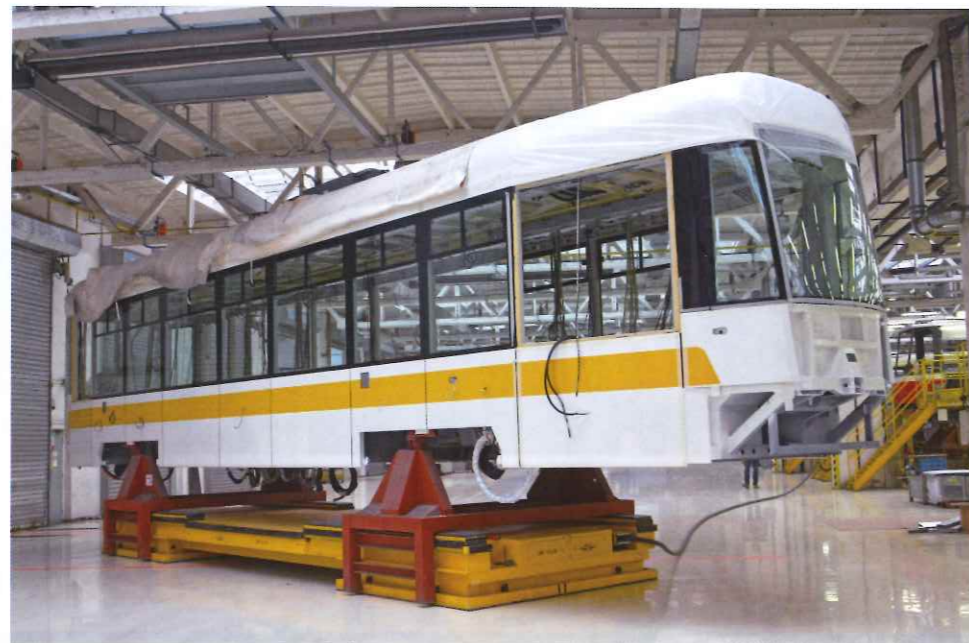
Presun hrubé stavby vozu pomocí vzduchového přepravku z lakovny do montážního stání.
